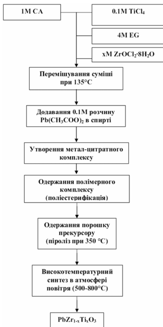
Рис. 1. Схема золь-гель синтезу.
